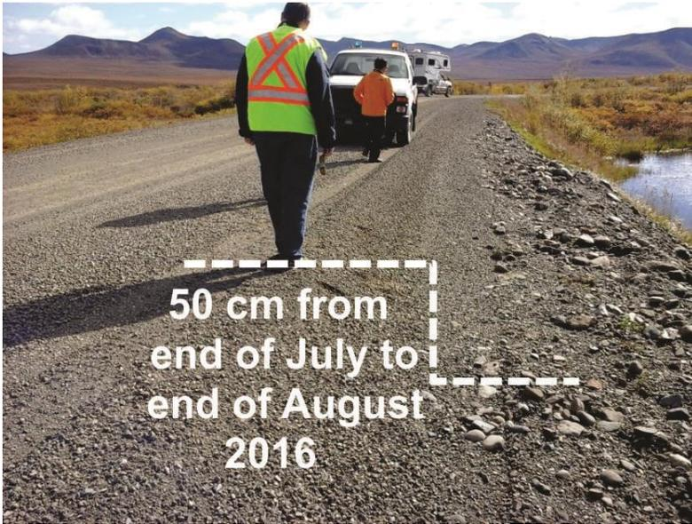
Figure 3.4.1 Subsidence observed at site DH103.
